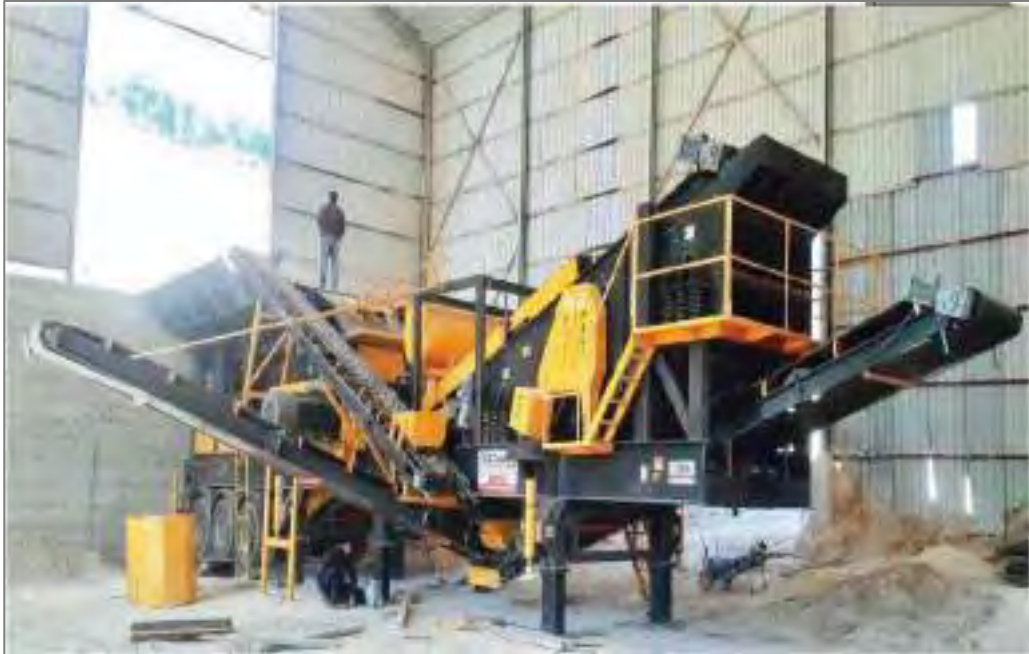
Şekil 110 Kırma Eleme Tesisi Görüntüsü.
