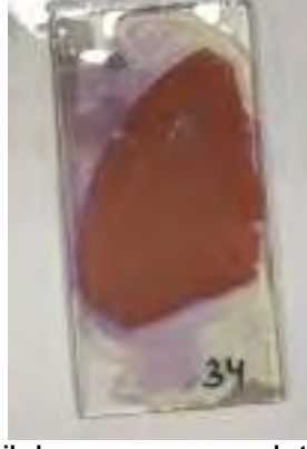
Şekil 70 17534 No' lu örneğin alizarin kırmızısı ile boyanması sonucunda tamamına yakınının boyandığı tespit edilmiştir.
