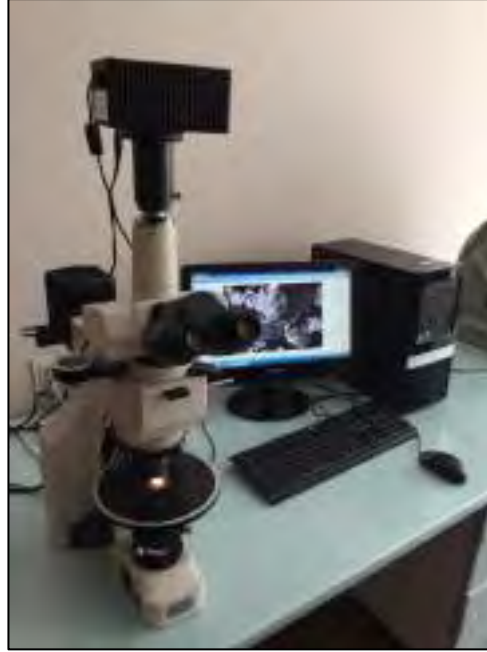
Şekil 34 İnce kesitlerin incelenip fotoğraflandığı Nikon Eclipse E400 POL marka mikroskop.
