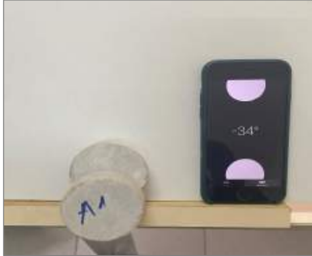
Şekil 72 Tilt deney düzeneği ve uygulamasından genel bir görünüm.
