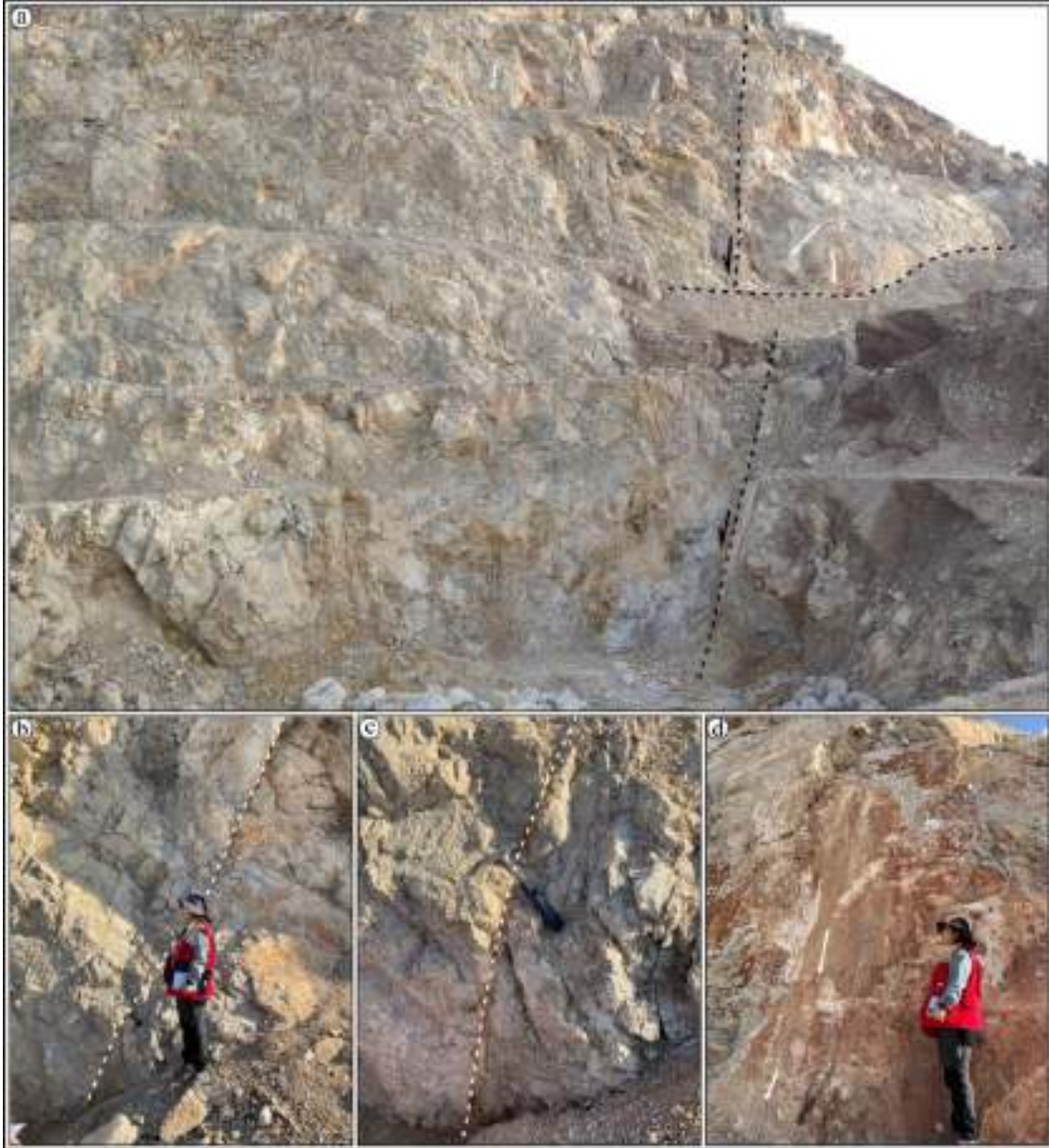
Şekil 39 Ruhsat alanı içerisinde gelişmiş olan eğim atımlı fayların arazideki görünümü (a, b, c, d).
